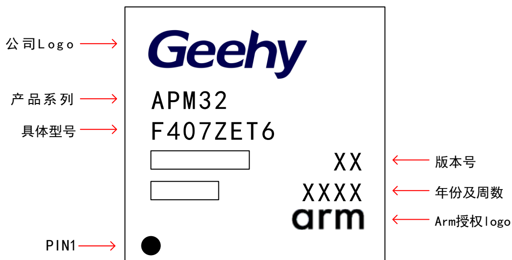
图 22 LQFP144 -144 引脚，20 x20mm 示意图
