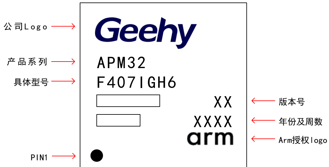
图 31 LQFP64 - 64 引脚, 10 x 10mm 示意图
